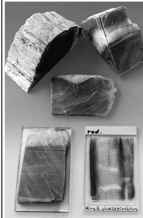
Die Herstellung von orientierten Kieselholz-Dünnschliffen. Aus Kelber 2007.
